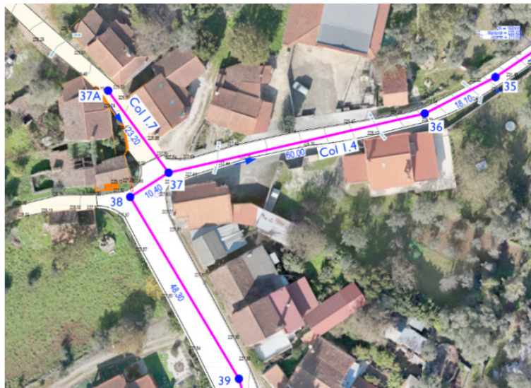
Figura 8: Representação esquemática da rede – troços de coletores e caixas de ramal de ligação devidamente georreferenciados e codificados.
