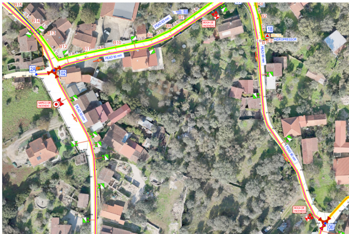
Figura 6: Representação esquemática da rede de Abastecimento de Água.
